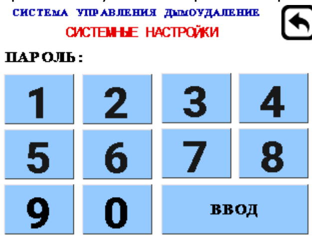
Рис. 16. Меню ввода пароля доступа к системным настройкам
